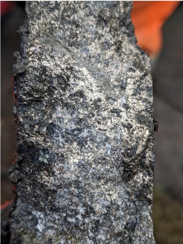
**Fig. 3 :** Échantillon type provenant de la première rainure de la nouvelle zone. La roche d'apparence mafique présente des amas semi-massifs de pyrrhotite, localement avec de la chalcopyrite interstitielle et des traces d'arsénopyrite.
