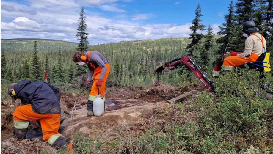
**Fig. 2:** Les employés de Stelmine effectuant un décapage avec une mini excavatrice et réalisant l'échantillonnage en rainures sur le nouveau secteur.
